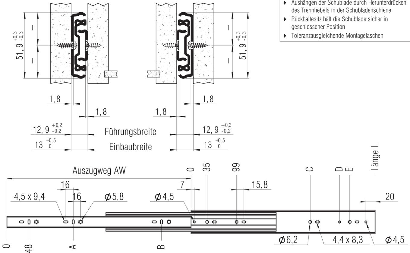
Anschraubbohrungen für 3,5 mm Spax-Schraube
